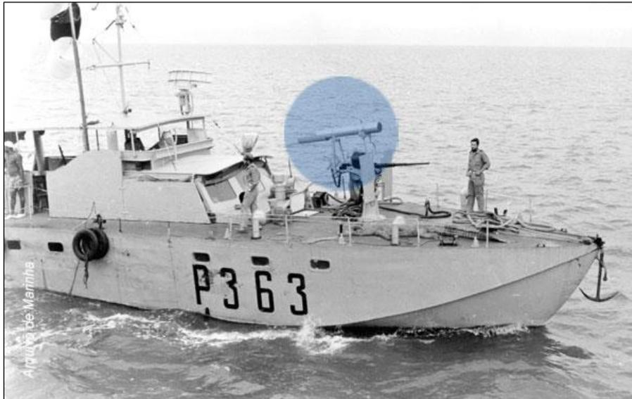
Apenas como um exemplo de equipamento modificado, instalado em algumas das LFP, repare-se no lançador de foguetes montado inicialmente na LFP "Bellatrix", comparativamente ao modelo que outras vieram a instalar posteriormente como o da LFP «Aldebaran».
